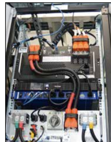
Inversor 890GT-R: arquitetura modular garante escalabilidade
