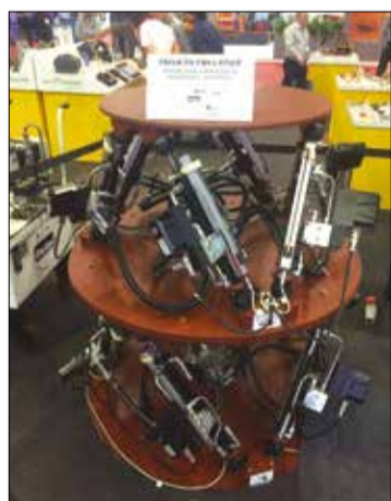
Controlados por computador, cilindros hidráulicos atenuam oscilações do mar
